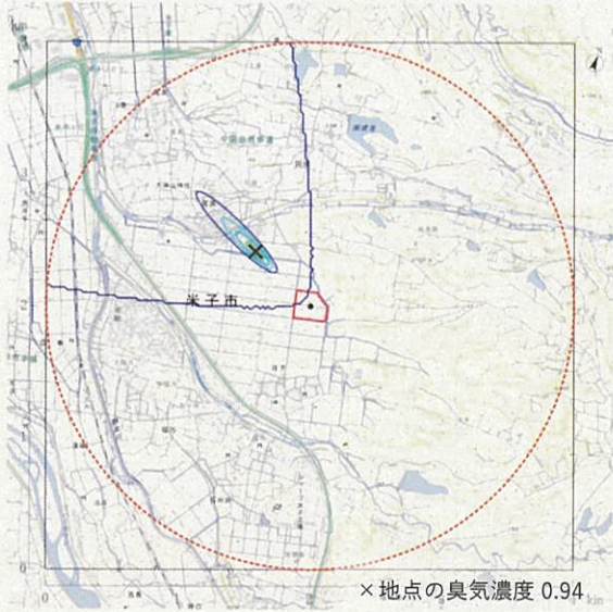
◆煙突排ガスによる悪臭の大気拡散予測結果 (北西方向へ風が吹いたとき)
