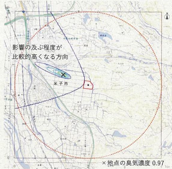
◆煙突排ガスによる悪臭の大気拡散予測結果 (寄与濃度が最大となる時)
