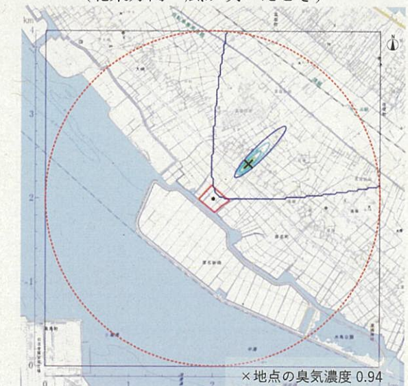
◆煙突排ガスによる悪臭の大気拡散予測結果 (北東方向へ風が吹いたとき)
